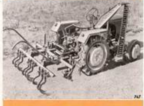
Nur für Arbeiten im Hanggelände ist ein Feinsteuerer nötig.
