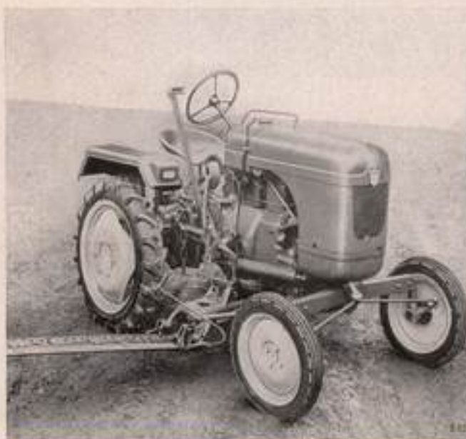
Der Handaufzug dient wahlweise zum Aufheben des Mähwerks oder des Universalgeräterahmens.
