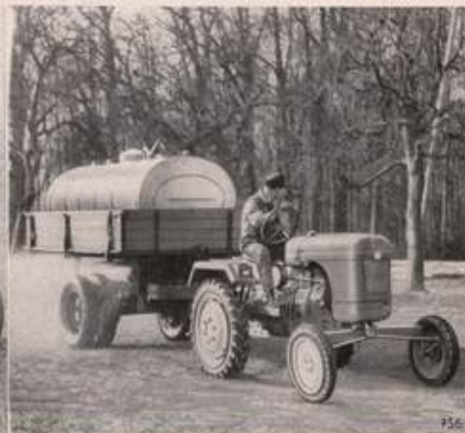
Besonders vorteilhaft ist seine fahrabhängige Zapfwelle bei den verschiedensten Transportarbeiten.
