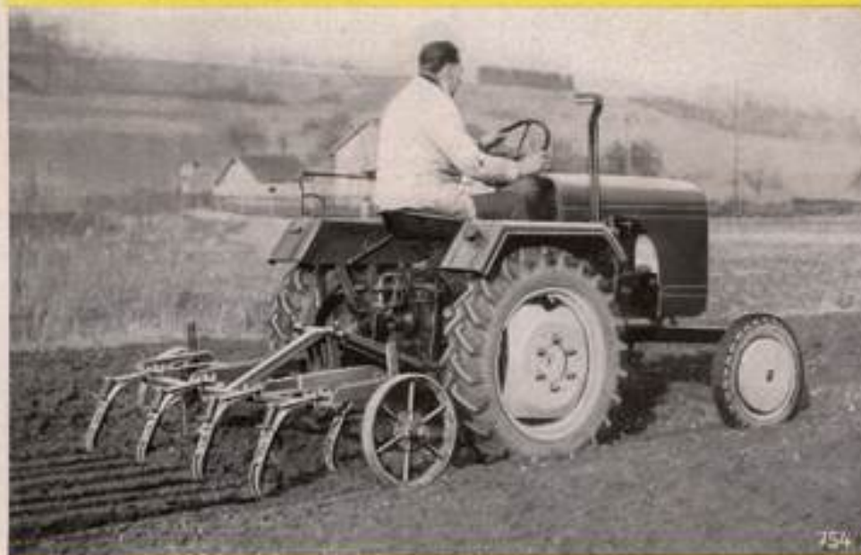
Alle vorhandenen Gespanngeräte lassen sich nach geringem Umbau vollwertig weiterverwenden.
