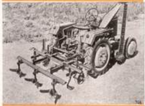
Der A16 bearbeitet 3 Reihen auf einmal.
