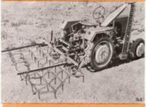
Als Eggenbalken dient der Rahmen des Vielfachgerätes.
