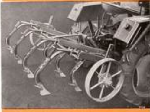
Die Grubberzinken lockern gleichzeitig die Schlepperspur.
