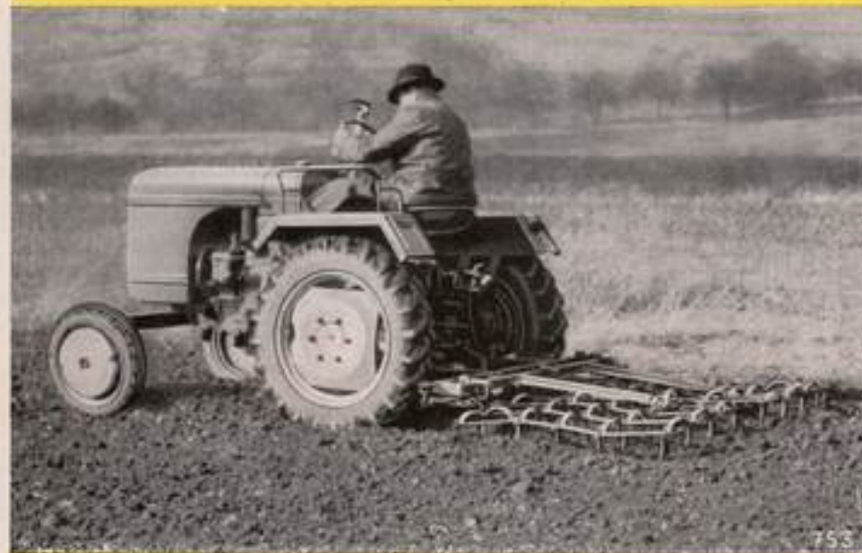
Jede 2 Meter breite Gespannegge läßt sich an den A 16 anbauen.
