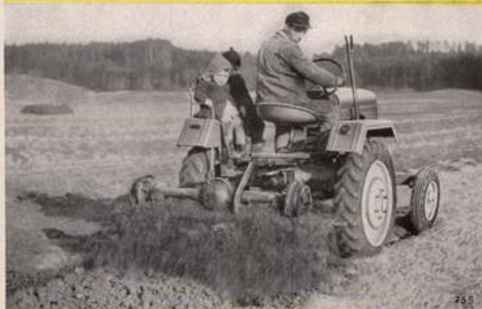
Die Saat kann ein A 16 mit einmal fahren durch Koppeln von Bodenfröse und Sämaschine erledigen.
