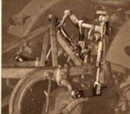
Der AP 17 wird auch mit Dreipunktaufhängung geliefert.
