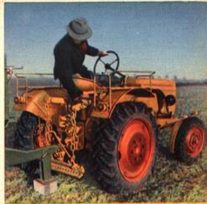
Das Aufsatteln eines Einachsanhängers erfolgt mühesparend mit dem hydraulischen Kraftheber.
