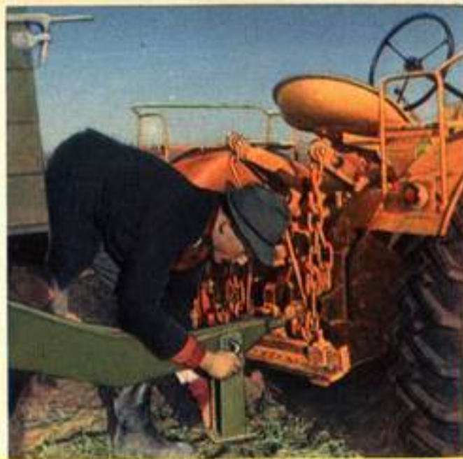
Das Aufsatteln eines Einachsanhängers erfolgt mühesparend mit dem hydraulischen Kraftheber.
