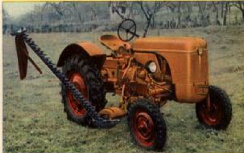
Das Heben und Senken des Mähbalkens kann auch mit dem hydraulischen Kraftheber erfolgen.
