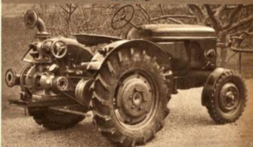
Die verschiedenartigsten Geräte lassen sich anbauen, z. B. Wasser- und Güllepumpen mit einer Leistung von 25 m³/Std.
