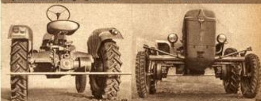
Spurverstellung von 1250—1650 mm bei großer Bodentfreiheit und tiefer Schwerpunktlage.
