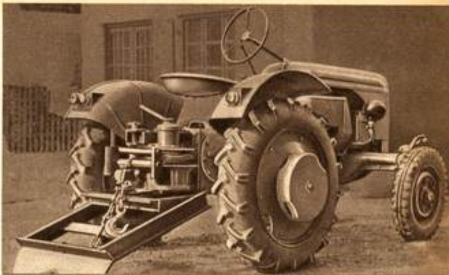
Die Seilwinde mit Schlepper AP 17 hat eine Zugleistung von 2500 kg.
