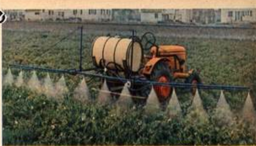
Bei der Schädlingsbekämpfung beträgt die Arbeitsbreite 6 m.
