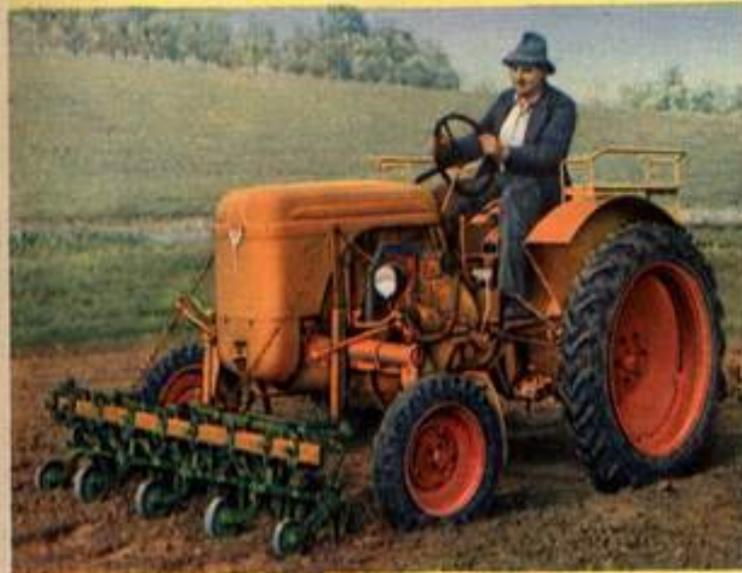
Die vorn oder in der Mitte angebaute Hackmaschine erübrigt den Feinsteuerer.
