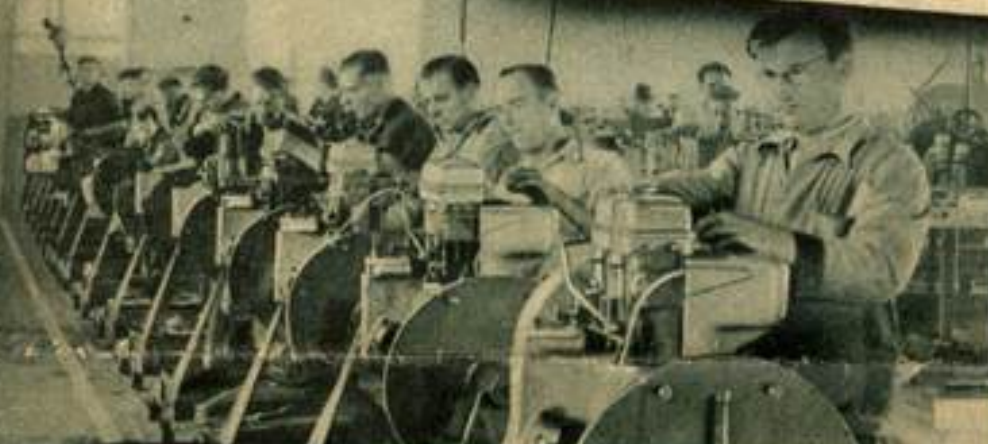
Vielen Prüfungen ist der luftgekühlte, 18-PS, -2-Zylinder-Dieselmotor unterworfen, bis er zum Einbau gelangt.
