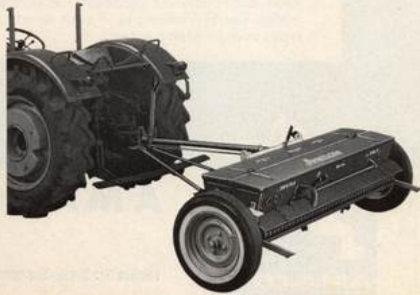
LZ 200, ausgestattet mit ausgedienter PKW-Bereifung
