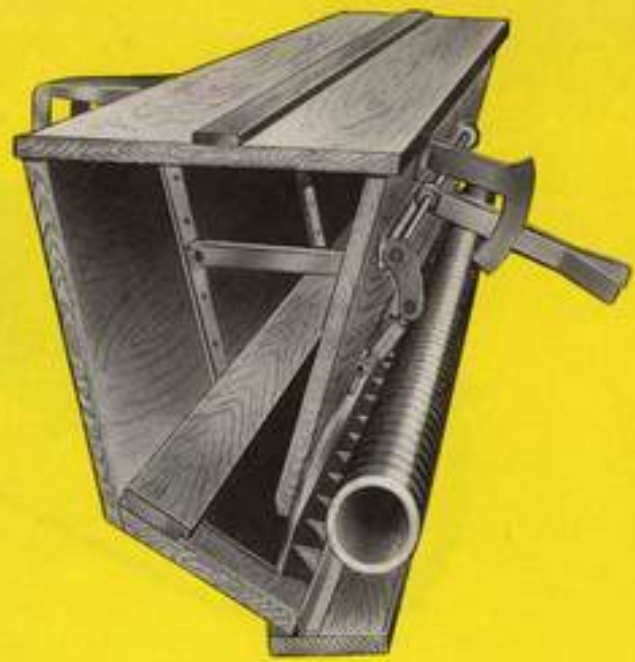
Prinzip L mit einer Streuwalze für ebenes Gelände
