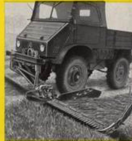
Das **Laufrad** macht sich bei größeren Mäharbeiten an Straßenrändern bezahlt. Der Innenschuh wird mit dem Rad vom Boden abgehoben und so der übergroße Verschleiß der Innenschuhsohle – die sonst auf der Fahrbahn gleiten würde – verhindert.
