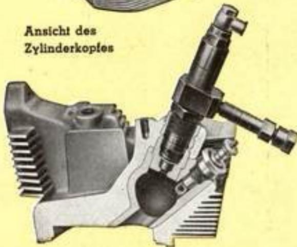
Schnitt durch Zylinderkopfunterteil mit Wirbelkammer
