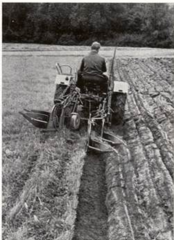
TWAS 171, 2-furchig, mit Handheber 121. Überlastungssicherung an den Pflugkörpern.
