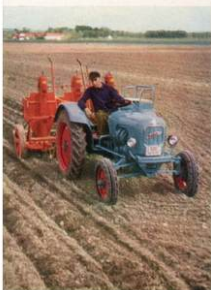
TIGER mit angehängtem 3-reihigen Kartoffellegeautomat
