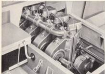
Der spezialluftgekühlte Motor liegt innerhalb des Fahrerhauses und ist nach Abnahme der Motorhaube überall leicht erreichbar.
