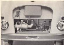
Durch Abnehmen des Frontzergitters erhält man leichten Zugang zur Heizungs- und Klima-Anlage und dem Hauptbremszylinder.
