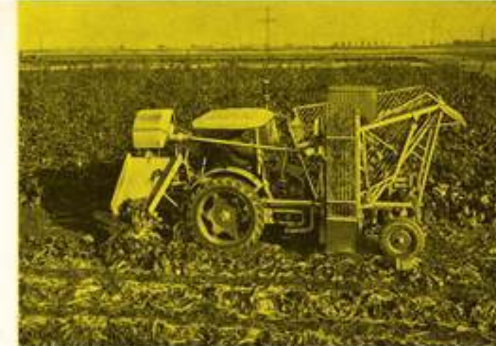
Durch den aufgesattelten Bunkerköpfröder wird der Geräteträger zur selbstfahrenden Vollerntemaschine bis 2 ha Tagesleistung.
