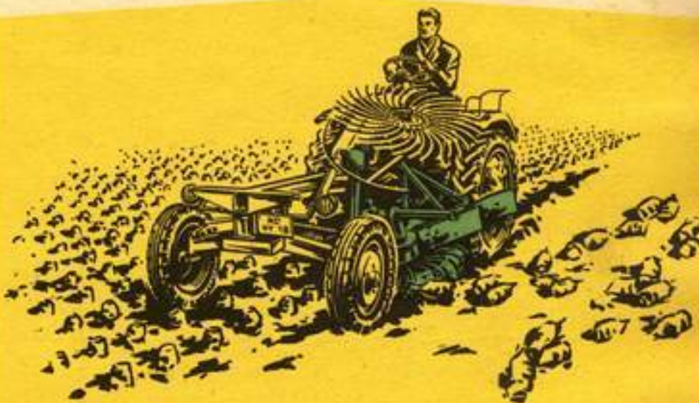
Ein Mann setzt den Kartoffelvorratsroder auch zum breitwürfigen Roden der Zucker- oder Futterrüben ein.
