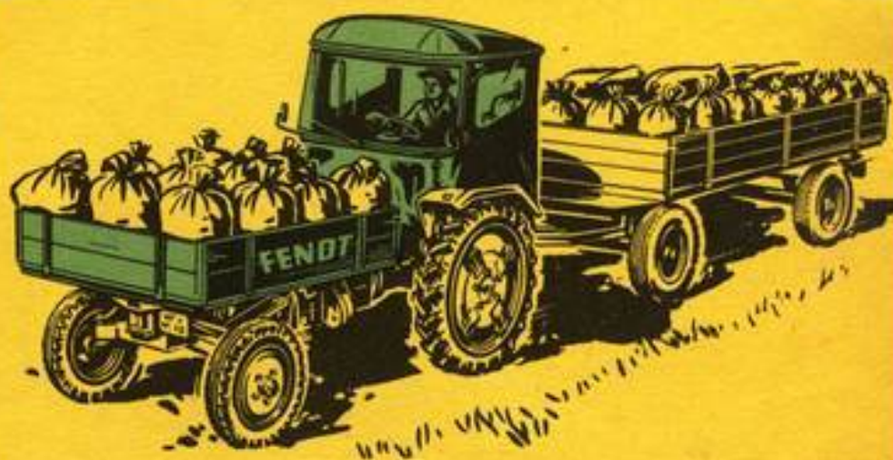
Ein Mann benutzt den Fendt-Geräteträger vorteilhaft als Zugmaschine. Die Nutzlast der Ladepritsche erhöht gleichzeitig die Zugkraft.
