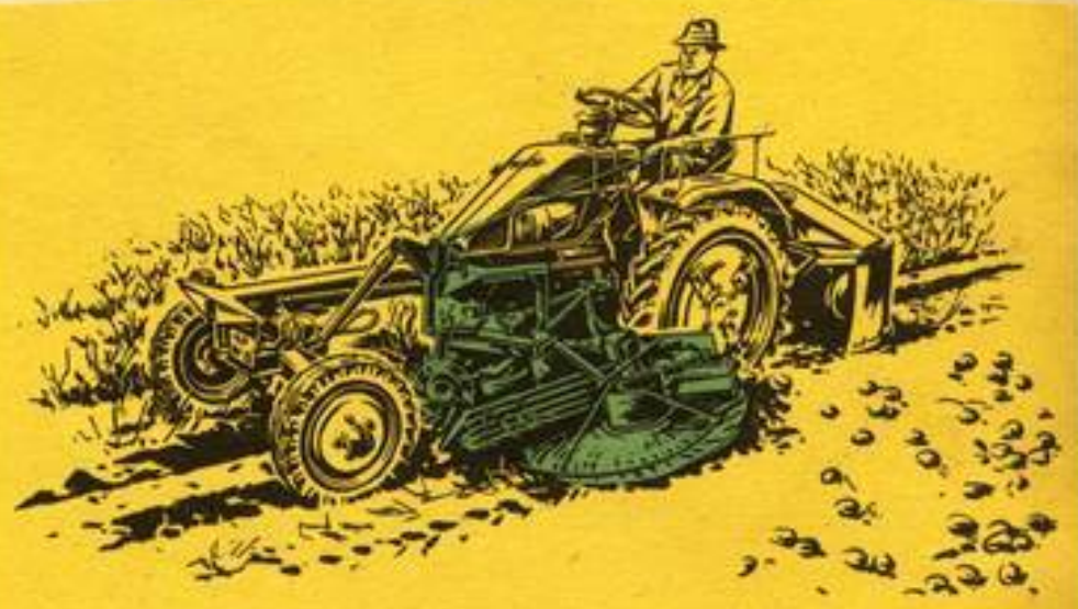
Ein Mann kann mit dem neuen Kartoffelvorratsroder in einem Arbeitsgang das Kraut schlagen und die Kartoffeln roden.
