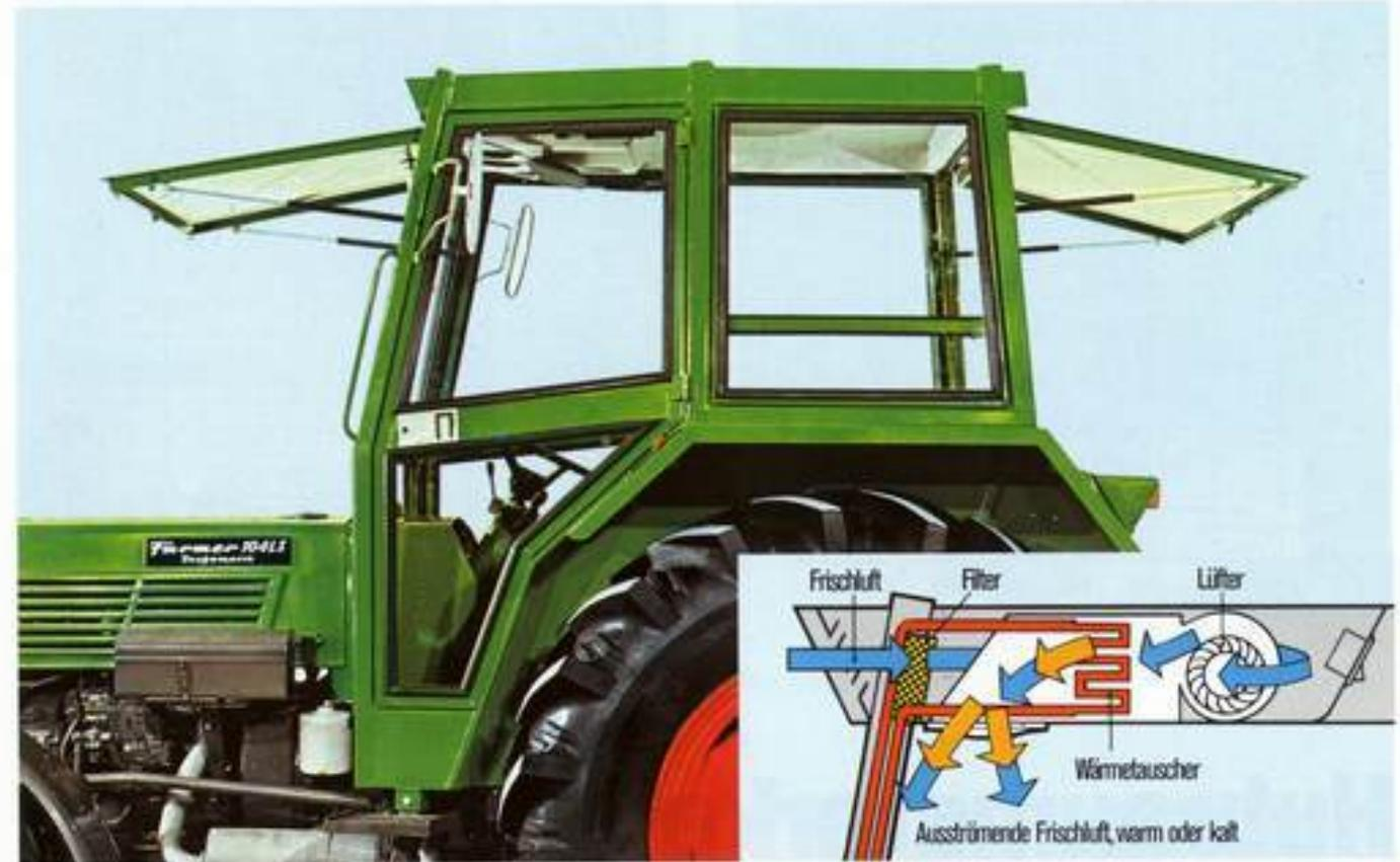
Warmwasserheizung und Belüftungsgebläse sind im Dach der LS-Kabine eingebaut. Front- und Heckscheibe können ausgestellt werden.
