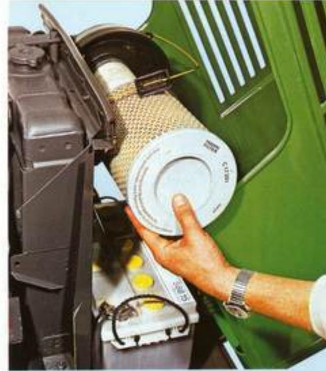
Der Trockenluftfilter läßt sich leicht reinigen.
