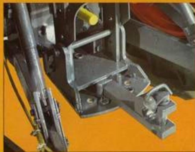
Unterhalb der Zapfwelle können Zugpendel, Hitchhaken oder Anhängerkupplung angebracht werden.
