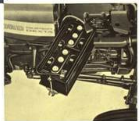
Batterie-Halterung Eine kleine schöne Erleichterung für die Wartung: die Batterie lässt sich mit der Halterung ausschwenken.
