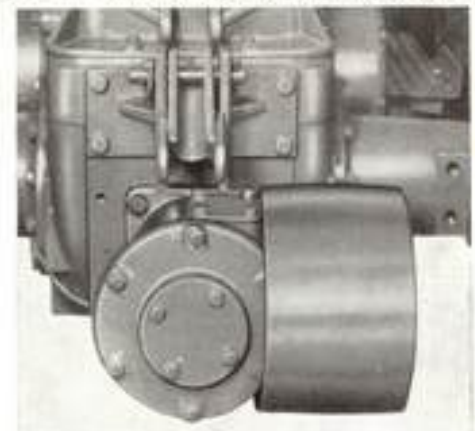
Riemenscheibe (Sonderausr.) vierfach versetzbar
