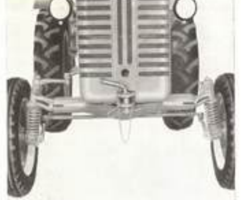
Pendelnd aufgehängte, gefederte Vorderachse
