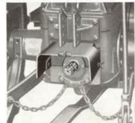
Zapfwellenschutzschild (wird serienmäßig mitgeliefert)
