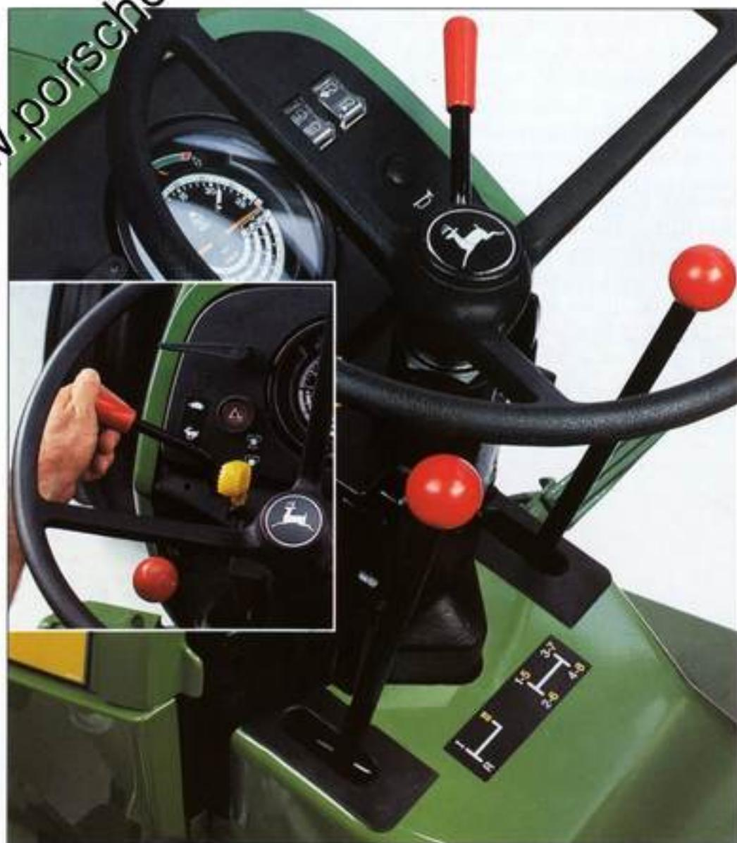
Leicht geschaltet – das 8/4-Gang-Synchrongetriebe. Je 4 fein abgestufte Gänge in 2 Gruppen bietet das John Deere Synchrongetriebe. Die 4 ebenfalls synchronisierten Rückwärtsgänge sind in einer Gruppe zusammengefaßt. So schalten Sie schnell und bequem die richtige Geschwindigkeit für die jeweilige Arbeit.
