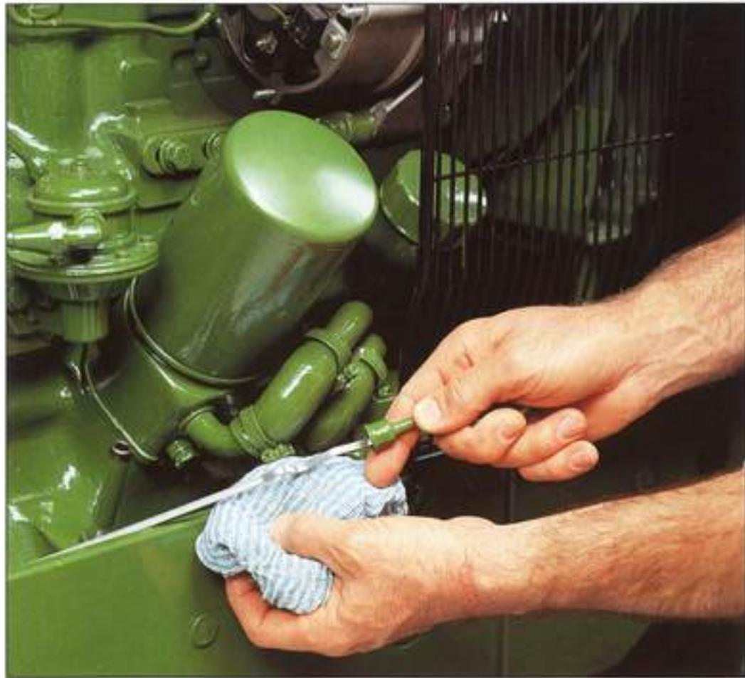
**Einfache Wartung spart kostbare Arbeitszeit.** Die Lebensdauer des Motors wird durch vereinfachte tägliche Wartung verlängert. Alle Wartungspunkte sind leicht zugänglich an der rechten Traktorenseite angeordnet.
