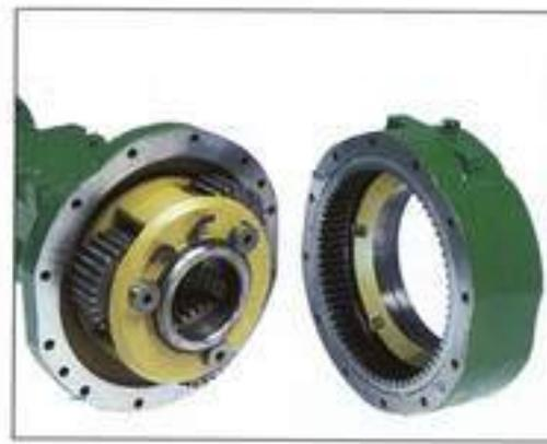
**Planetenendtriebe.** Ein weiteres Beispiel für die Zuverlässigkeit von John Deere – die Endantriebe verteilen die Last auf drei Punkte im Gegensatz zu herkömmlichen Antrieben auf nur einen Punkt.
