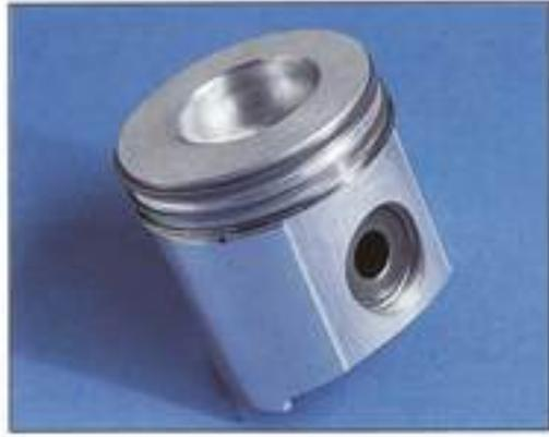
**Neu von John Deere: Leichtlaufkolben.** Spezielle Aussparungen im Bereich des Kolbenbolzens reduzieren die Reibung an den Zylinderwandungen und ermöglichen somit bessere Kraftstoffausnutzung und längere Haltbarkeit.
