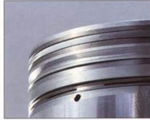
**Neu von John Deere: hohe Anordnung der Kolbenringe.** Das Höherlegen der Kolbenringe bewirkt höhere Verdichtung, bessere Verbrennung und sichere Kaltstarts.
