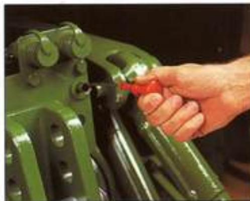
**Einfache Wartung.** Da das Getriebeöl gleichzeitig als Hydrauliköl genutzt wird, werden beide Systeme mit nur einem Meßstab kontrolliert, und ebenso wird nur durch eine Öffnung Öl eingefüllt.
