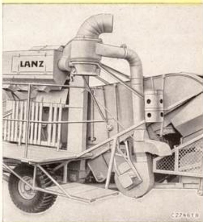
Absackstand, Sortierzylinder mit 3 Abfüllstationen, Spreuburgung
