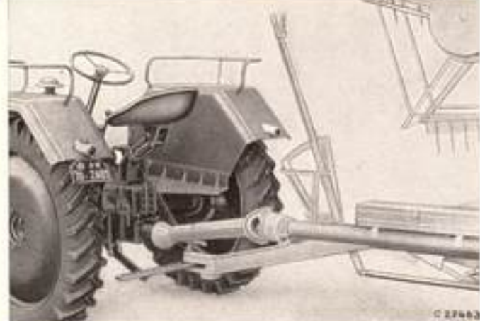
Bedienungshebel für Schneidwerk, vom Schleppersitz aus verstellbar
