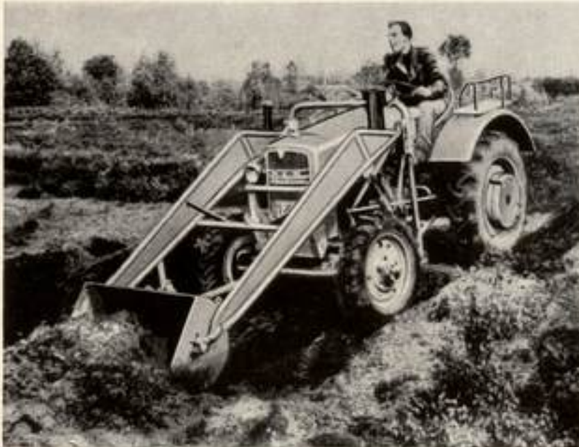
Sicheres Arbeiten bei entlasteter Hinterachse
