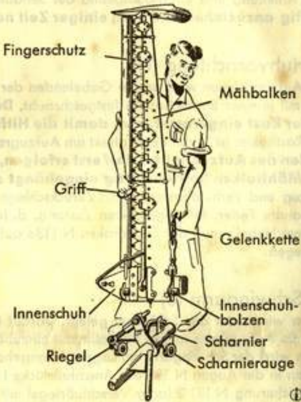
Abb. 2. Einhängen des Mähbalkens mit angelegtem Fingerschutz.
