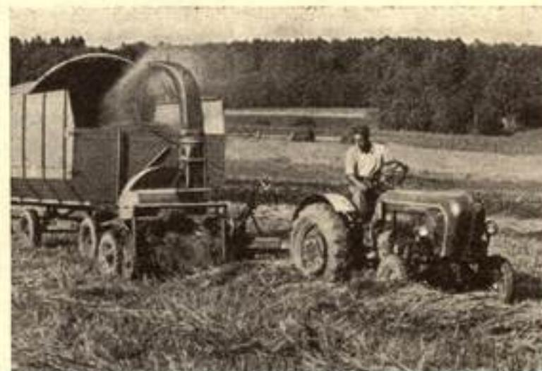
Beim Schwadhäckseldrusch mit einem Porsche-Schlepper bewährt sich besonders die unabhängige Zapfwelle.
