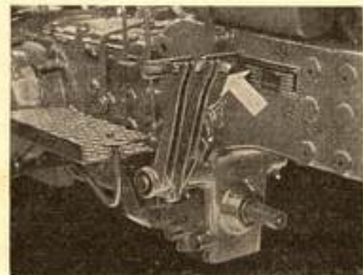
Beim Befahren eines öffentlichen Weges muß die Kopplung der beiden einzeln zu betätigenden Radbremsen wieder hergestellt werden.
