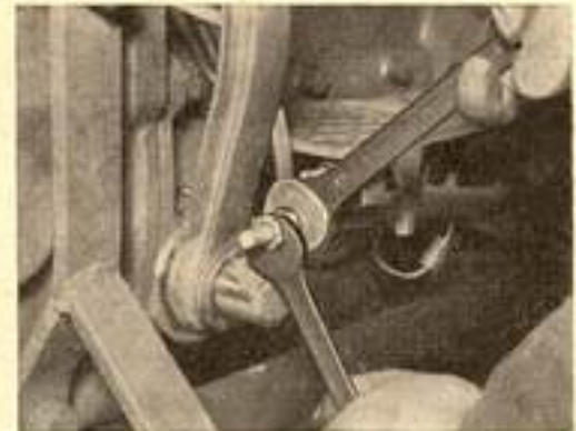
Das Nachstellen der Bremsen mit Hilfe zweier passender Schlüssel kann notfalls auch auf dem Acker gemacht werden.
