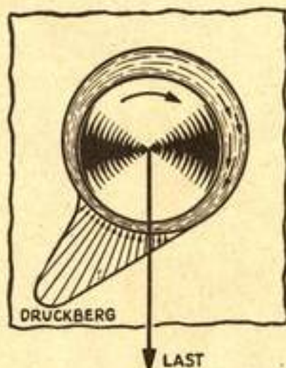
Bild 3: zeigt die sogenannte Schmierkeilbildung. Dort, wo der Druck auf die Welle erfolgt, wird das Öl zwischen Welle und Lagerwand gepreßt, so daß die Welle von ihrer ruhenden Stellung in die schwimmende gebracht wird. Dabei entsteht ein Druckberg, dessen Kräfte durch die Größe der Pfeile ausgedrückt ist.
