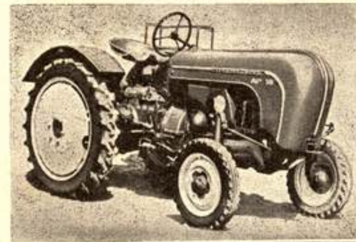
← PORSCHE-DIESEL-Schlepper AP 18, 18 PS, 2 Zylinder. Mit veränderter Einspritzung und deshalb günstiger Leistung im mittleren Drehzahlbereich.
