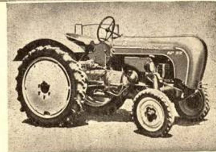
→ PORSCHE-DIESEL-Schlepper AP 22, 22 PS, 2 Zylinder. Besonders leichter Schlepper, durch ölhydraulische Kupplung hervorragend gesichert geg. Überlastung.
