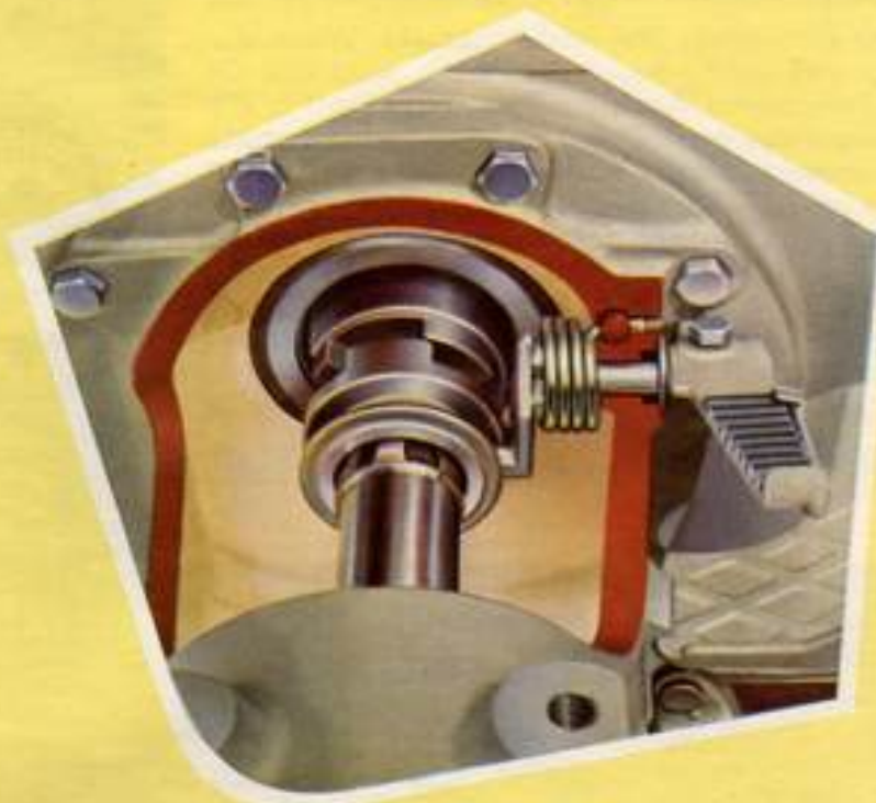
Die Differentialsperre verbindet die beiden Antriebsräder fest miteinander. Dadurch greifen beide Räder gleichzeitig.
