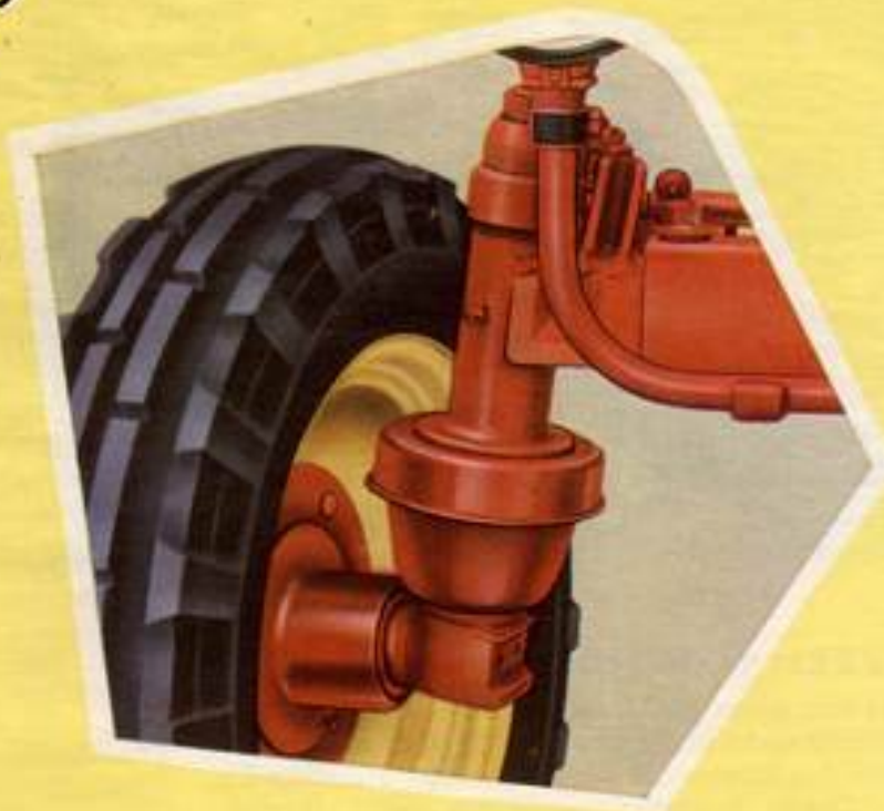
Die gummigefederte Vorderradaufhängung fängt die harten Stöße, die sich beim Befahren der Feldwege ergeben, auf – und schützt damit die Gesundheit des Schlepperfahrers.
