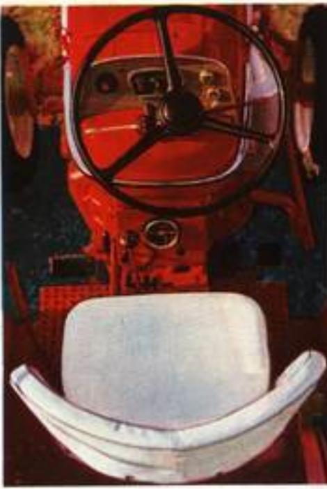
Darum hat RENAULT den Sitz extraweich, extra tief parallelgefedert und verstellbar gemacht - Ihrer Gesundheit wegen. Die Liebe zum Detail ist deutlich sichtbar bei der Anordnung der Pedale für Kupplung und Bremsen, Gas und Differentialsperre, bei den Hebeln für Handgas, Blinker, Getriebeschaltung, Zapfwelle, Handbremse und Hydraulikanlage - sie alle liegen tritt- und griffgerecht.
